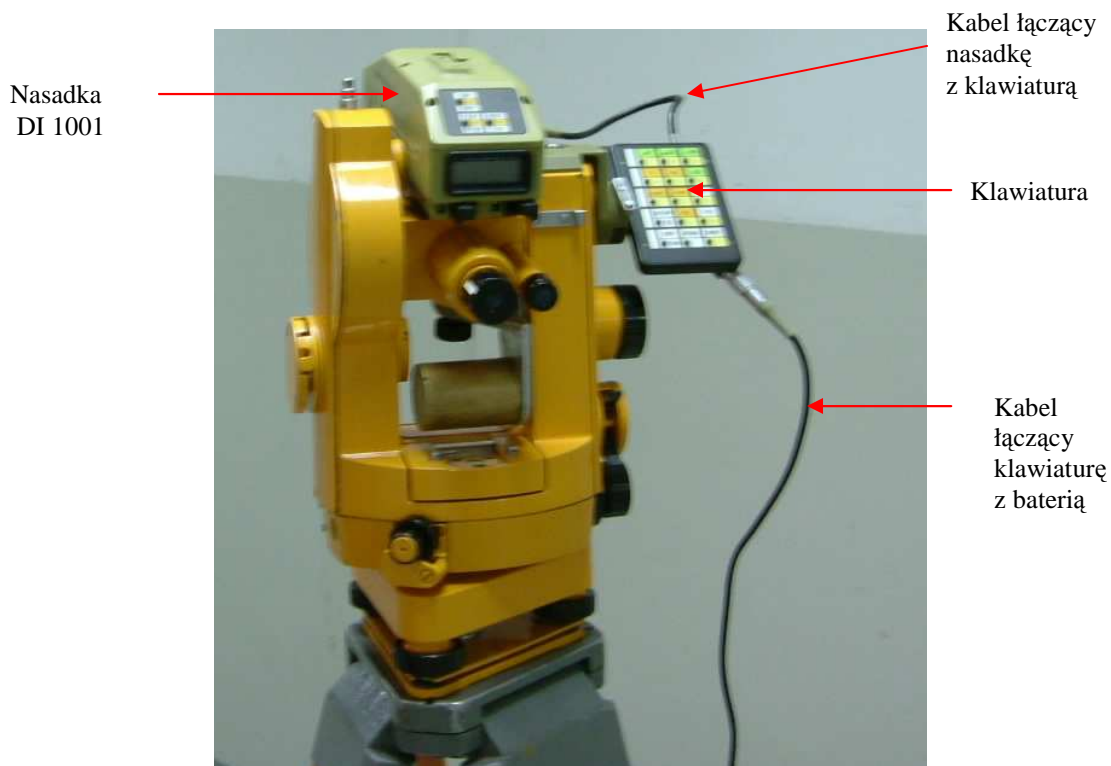
Rys. 4. Nasadka dalmiercza DI 1001 nałożona na lunetę teodolitu.
